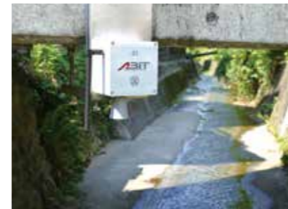
エイビットが開発した小型・軽量の水位計測センサー
