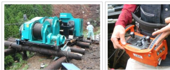
油圧式集材機と操縦用無線リモコン
