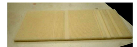
開発品：絣板をデジタイザーと 3D プリンターを用いて復元
