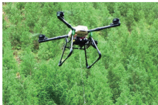
防護柵の資材を運搬するドローン
