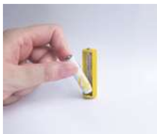
MaBee (単3電池型) に単4電池を挿入して使用
