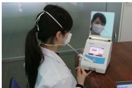
マスクと顔の密着性（漏れ率）の測定が可能
